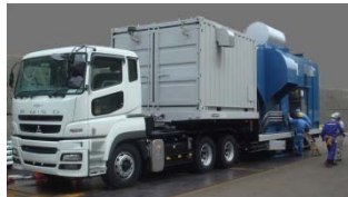
①空冷式非常用発電装置を高台に設置
