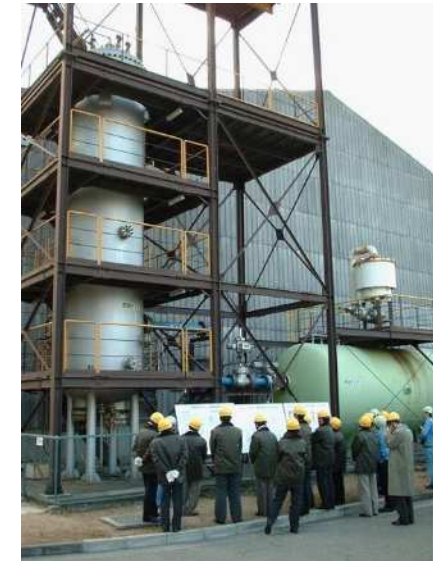
高性能蓄圧タンク実圧注入試験
