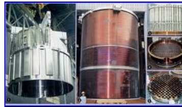
原子炉炉内構造物
