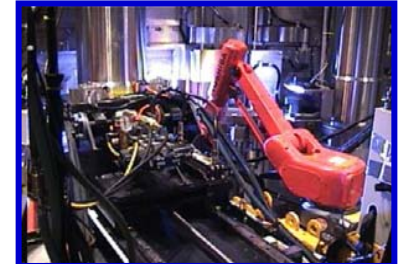
炉内溶接ロボット
