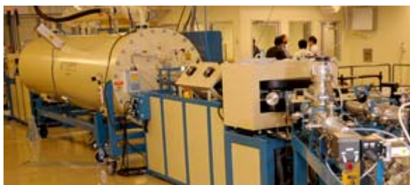
図1 UTのイオンビーム材料研究室はオークリッジ国立研究所との共同利用設備です。このタンデム加速器は3MVの加速能力、2つのイオン源、3つのビームライン、4つの照射チャンバーがあり、照射効果をはじめとして、イオン-固体相互作用、材料改質などに関する研究に利用されています。
