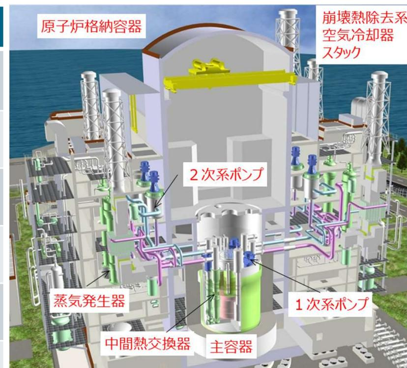
**ナトリウム冷却タンク型高速炉**
