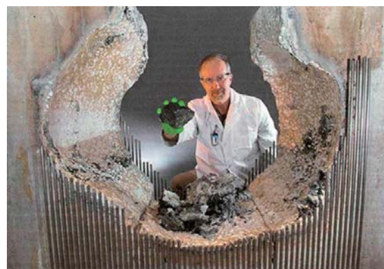
コリウム・コンクリート反応によるコンクリートの侵食実験のよう (Argonne National Lab, USA)
