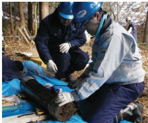
地中の土壌をサンプリングし、セシウムの濃度を調べる
